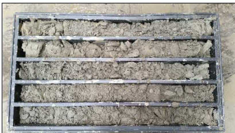
Foto n. 11: sondaggio S. S. 1 mt. 15.00-20.00
