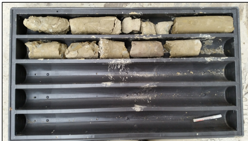
Foto n. 19: sondaggio S. S. 2 mt. 25.00-30.00
