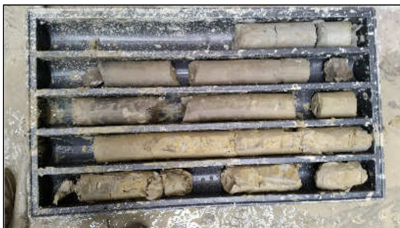
Foto n. 12: sondaggio S. S. 1 mt. 20.00-25.00
